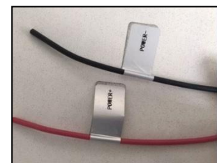
Рис. 3.10.1-A- Провод питания блока ECU
